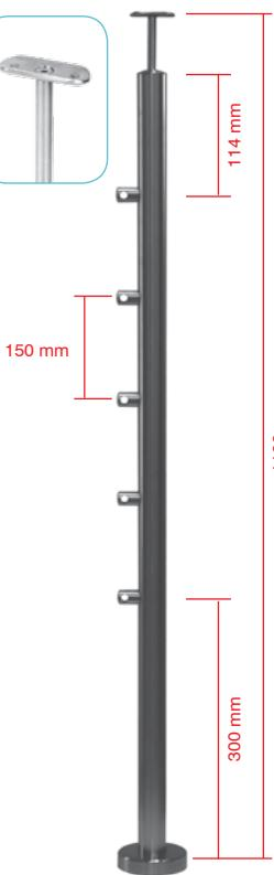
**Caposaldo diam. 33,7x2mm H.1100mm con supporto a pavimento e 5 supporti per tondo 10mm, fisso.**
